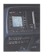
1987 年発売のクラウンに搭載されたエレクトロ・マルチビジョン・システム(EMV)は、トヨタ自動車との共同開発によるカーナビゲーションシステムであり、日本の本格的なカーナビゲーションシステムの第1号ともいえる。このシステムは日本初の CD-ROM によるデジタル地図を搭載しており、カラーCRT ディスプレイに表示される地図上に自動車の位置と進行方向が表示された。自社の位置を知るロケーション技術は、推測航法と
