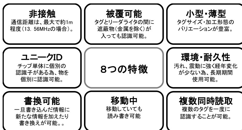
図表 3-1-4 IC タグシステムの特徴
