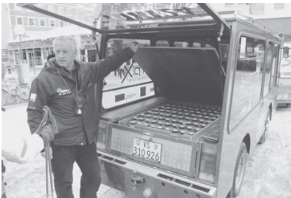
写真2 タクシーの荷台には鉛バッテリーがぎっしり
