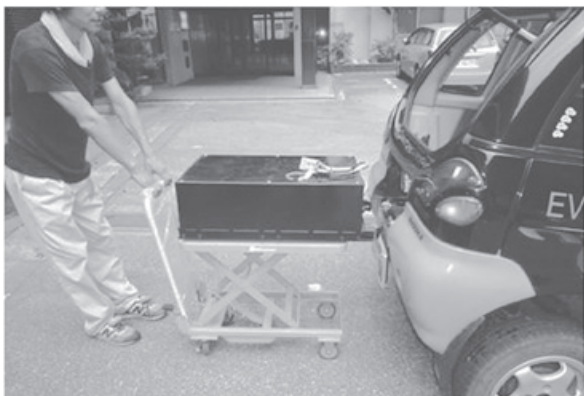
写真24 EVのバッテリーを交換しているところ。重いで交換には専用のジグを使う
