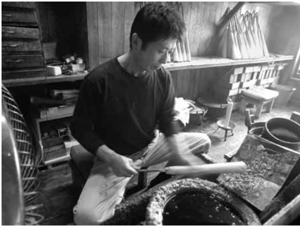
クリーム状の木ロウを手で直接塗り重ねていく。
