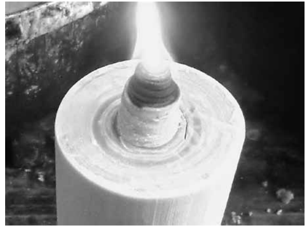
和ろうそくを上から眺めると、年輪模様はバームクーヘンのようにも見える。手と目の感覚だけでこのような均一な層を生み出すにはやはり熟練の技がある。
