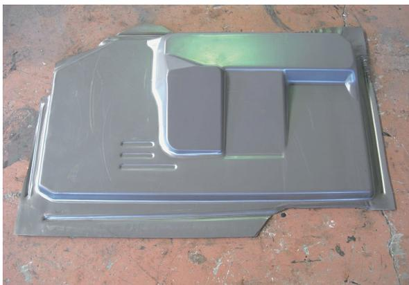
樹脂金型で成形した製品（バスの運転席フロア）
