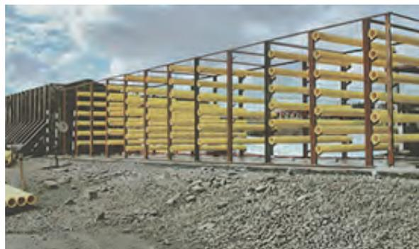
写真3 厨房内のガス爆発を模擬する野外実験装置（実験時には鉄骨の構造物の周囲をビニールシートで覆い、内部に水素混合ガスを注入・爆発させ、水素濃度の違いによる爆発の被害の違いを評価する。黄色のチューブは障害物を模擬したもの。）
