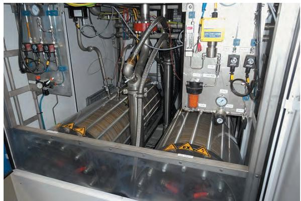
写真8 HYDROGENICS社製大型PEMタイプの電気分解水素製造装置
