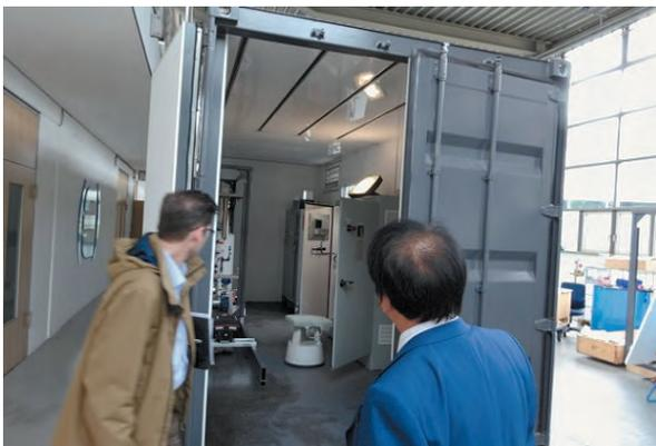
写真6 製作中の水素製造装置（小型のPEMタイプ電気分解水素製造装置を採用したオールインワンコンテナタイプ）
