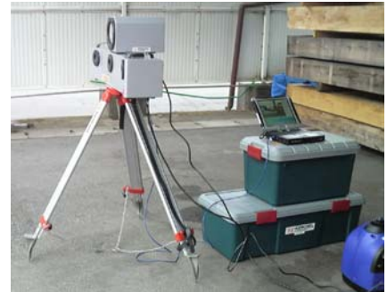
原木材積測定器本体と画像解析ソフトがインストールされたパソコン
