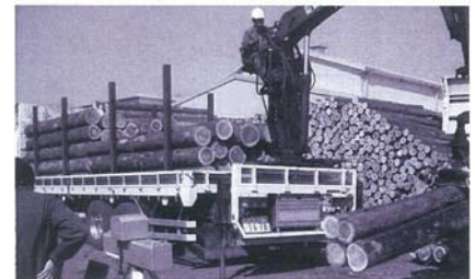
原木をクレーンでつり上げたまま瞬時に材積測定が可能
