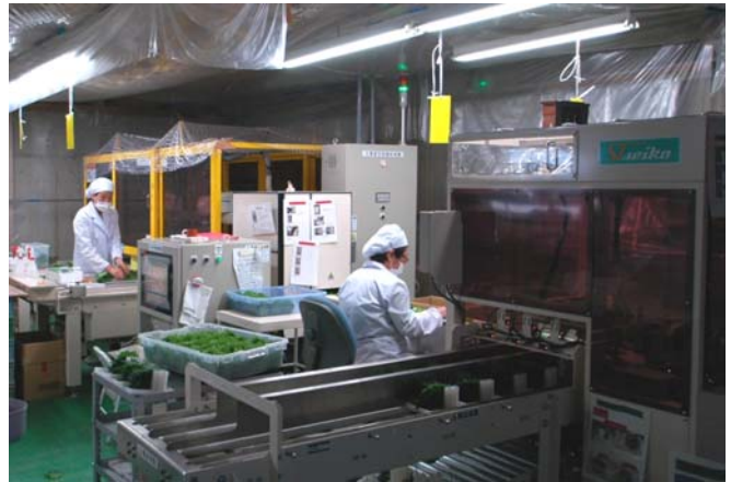
大葉選別装置による作業の様子（手前の装置から大葉を搬入し、人手による品質にかかわるキズや病葉の変形などの判別および仕分けを経て、後方の装置（センサー、ロボット）による大きさの判別・仕分け、整列を行うという工程）
