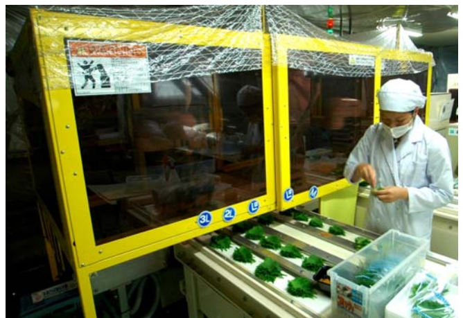
大葉選別装置による作業の様子（4段階の規格サイズに選別され、10枚重ねの束になってコンベヤ上に出てくる。それが人手によって包装される）
