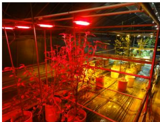
波長の異なるLED光によるモロヘイヤの栽培実験
