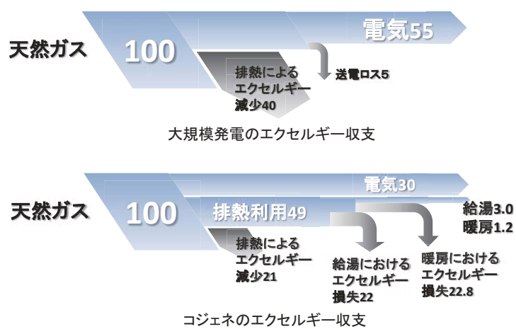
図9. 9 大規模発電およびコジェネシステムにおけるエクセルギー収支の例
