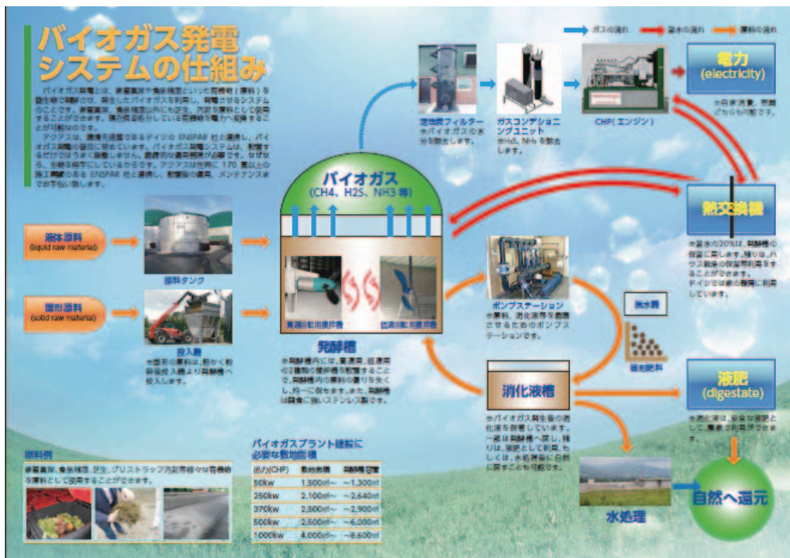
図 2. 2. 1 バイオガスプラントの処理フロー
