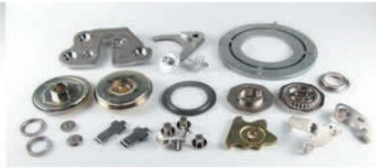
材料板厚を増減厚させ3次元 立体形状を成形する板鍛造技術
