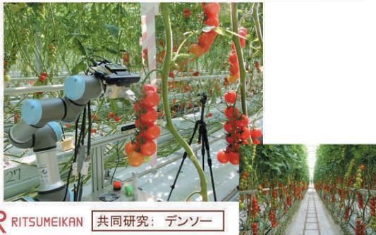
かに安く、必要な機能を備えたロボットを開発するかです。トマトは細くてセンサーで見えないところが多いが、昼間は困難だが夜間はセンシングできるので、夜間に稼働させるなどの工夫をおこなっています。トマト専用はさみで切りつつ、挟み、落とさずに運ぶことができる機械です。1回10秒ぐらいでできるようになっています。トマト収穫のロボット化は日本だけですが、やがて海外との競争になるので、精度が良く低コストの開発が重要です。
