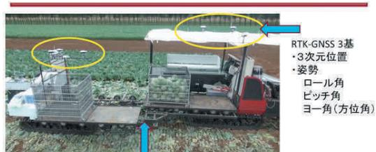
ディープラーニングによる検出とRTK-GNSSによる位置・姿勢角と油圧アクチュエータの制御による自動ドッキング
