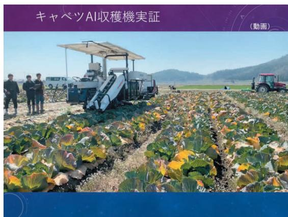
キャベツの自動収穫の、実証実験に協力しています。弊社も収穫機を利用しています。AIが収穫の管理をしてくれるので、ストレスも少なくなり、今年も実証に参加します。以前は、収穫に6～7名必要でしたが、ロボット化で3名に減員しました。大区画になれば、ロボットの普及は進むと思います。
