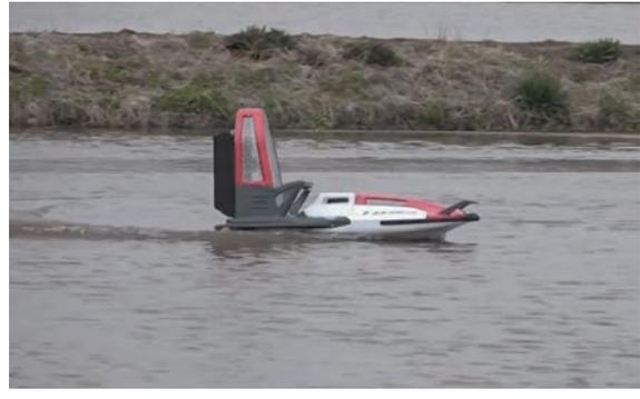
除草剤散布に適した機械として、ドローン以外にボートも開発しています。圃場の大型化により除草剤散布の手間は大きくなっています。大規模な圃場の中に人が入って行って除草剤をまくのは苛酷な作業です。稲の成長が初期、中期の段階で対応できて、軽量で苗を傷めないホバークラフトのような除草機械です。ホバークラフトのように浮遊する形式ですと100万円を超えてしまうので、スクリューではなくて後ろの扇風機を回しながら旋回するボートです。5リットルのフロアブル剤(除草剤)を積んだタンクがついており、後ろから滴下で垂らしながら散布します。滑るように行くので、苗を傷めることはありません。
