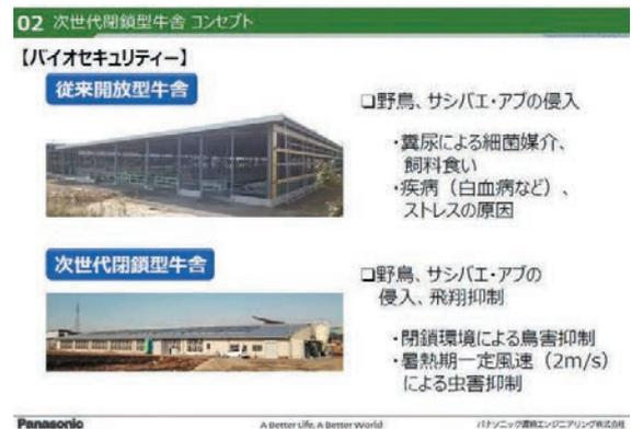
バイオセキュリティについては、従来の屋根と柱だけの牛舎では、外から野鳥や吸血昆虫がたくさん侵入しましたが、閉鎖型牛舎は換気開口部を除いて壁に覆われていますので、侵入が少なくなります。
