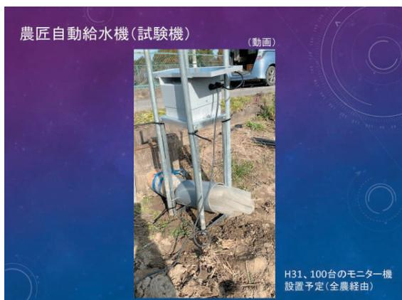
農匠ナビでは、オープン水路用の自動給水機の開発を行っています。用水路のゲートをスライドさせて水を止める方式は、流れてきたごみや藻などで完全に閉まり切らないことが頻発しています。ゲートは廃止して、先端にホースを装着し、ホースを上下させて給排水する簡単な装置を開発しました。現在、商品化の準備を行なっています。
