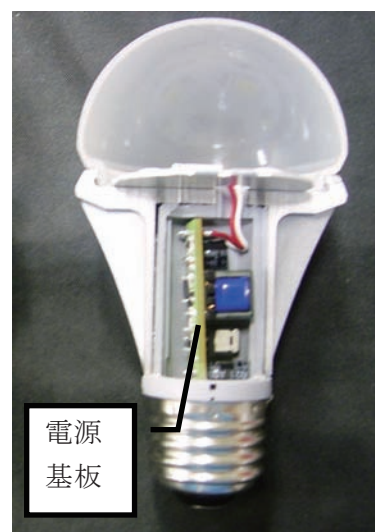
図 4.1-1 LED 電球断面
