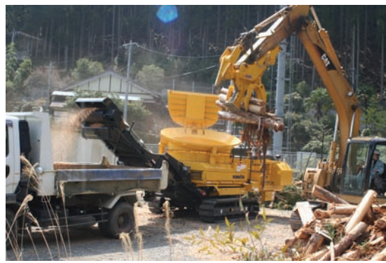
参考写真一16 自走式木材破砕機 による間伐材のチップ化 三重県多気郡大台町
