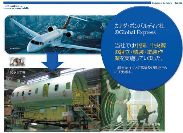
カナダのボンバルディア社の機体 (グローバル・エクスプレス) を20年以上に渡り製造しました。販売価格がカスタマイズによっては100億円以上するという豪華な航空機ですが、この機体の中胴と中央翼、主翼の組立と塗装、機装作業まで幅広く担当しました。三菱重工の方針によりカナダのMHICA社に作業が移管されたので、当社の作業者が立上げのため、出張して生産指導しています。
