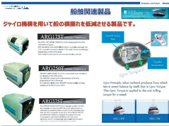
船舶関係では、船舶の揺れを低減させる装置の、アンチローリングジャイロ（以下、「ARG」）の開発、販売をおこなっています。30年前に三菱重工が衛星の姿勢制御技術を、民生品に転用して開発しました。開発当初から、当社が部品調達・組立・試験を担当して、波の揺れのシミュレーショ
