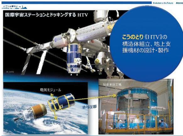
宇宙ステーション補給機HTV (H-II Transfer Vehicle、愛称：「このとり」) は、国際宇宙ステーションに食料、衣類などを供給する無人宇宙補給機ですが、その機体の一部の組立をおこなっています。宇宙環境での使用のため、製造環境や加工精度への要求が高く、現場管理にはより配慮しています。
