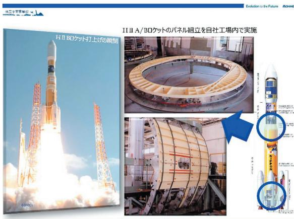
HTV打ち上げ用の、ロケットのパネルも生産しています。H2Bロケットの先端にHTVが入っており、宇宙で切り離されて、HTV単体で動きます。
