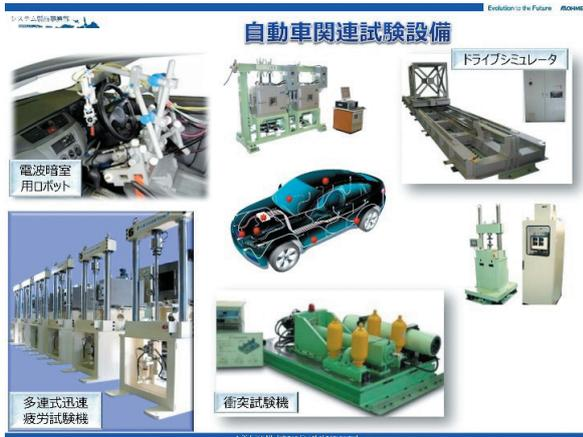
自動車関連は、疲労試験機、衝突試験機、ドライブシミュレーターなどを製造しています。
