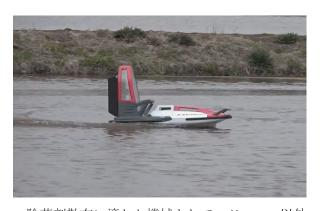
除草剤散布に適した機械として、ドローン以外にボートも開発しています。圃場の大型化により除草剤散布の手間は大きくなっています。大規模な圃場の中に人が入っていって除草剤をまくのは 苛酷な作業です。稲の成長が初期、中期の段階で対応できて、軽量で苗を傷めないホバークラフトのような除草機械です。ホバークラフトのように 浮遊する形式ですと100万円を超えてしまうので、スクリューではなくて後ろの扇風機を回しながら旋回するボートです。5リットルのフロアブル剤(除草剤)を積んだタンクがついており、後ろから滴下で垂らしながら散布します。滑るように行くので、苗を傷めることはありません。
