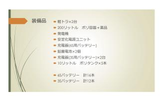
装備品は、軽トラック2台と200リットルのタンク、薬剤を入れたポリ容器、2,300ワット発電機、安定化電源のユニットが2台、充電用バッテリー16本とたくさんあります。蓄電池は、メインローター用のバッテリー2個に加えて、ポンプの可動用の小型バッテリー、制御機能用のバッテリーが別にあります。薬剤は10リットルのポリタンクを5本持ち200リットルの大きなポリから小分けにして注ぎ込みます。バッテリーはサイズ違いの物を、それぞれ16本、12本と保有しています。
