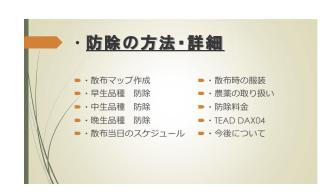
防除作業の詳細を説明します。各圃場で品種を委託者と確認し「散布マップ」を作成します。このマップでは、品種毎に色分けして判別し易くします。次に危険な場所、電柱や木などの障害物がないか確認します。またドローンを圃場内でどちら向きに飛行させれば効率的か飛行ルートを検討し、安全な離発着の場所を確認します。
