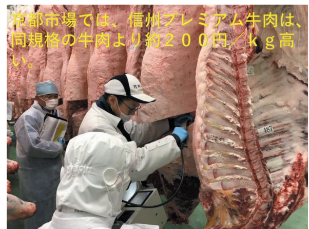
図4-11. 近赤外線分光装置でオレイン酸を測定している様子
