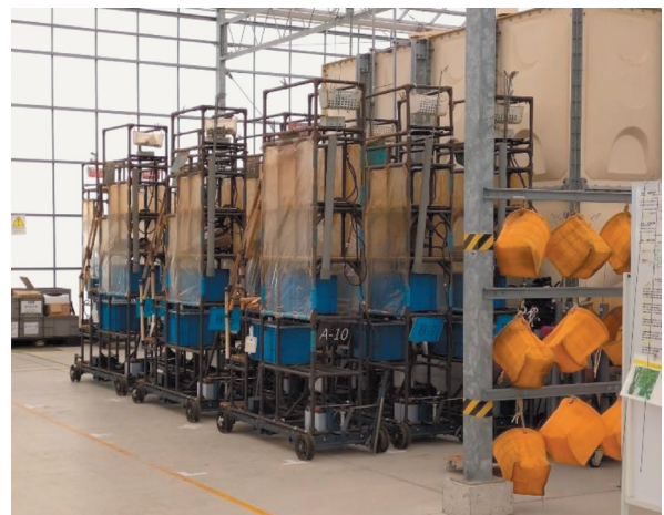
図6. 自作の高所作業用台車
