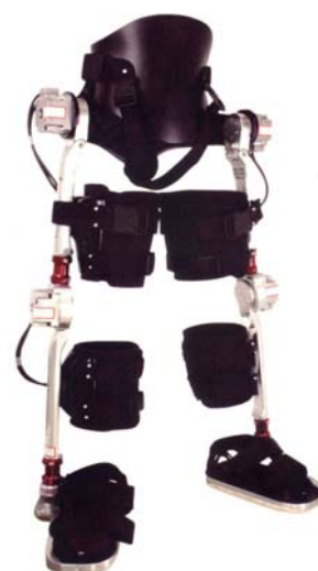
下肢機能を支援するパワーアシストロボット (豊田工業大学と共同開発)
