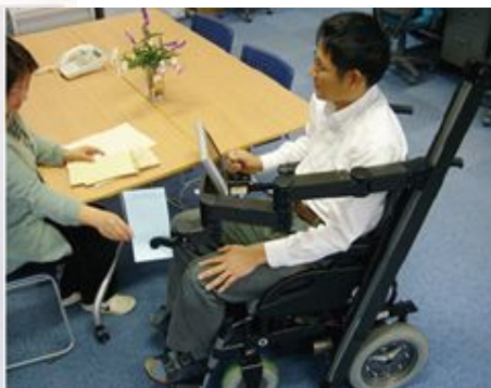
コンパクトアーム付き電動車いす (岐阜県情報技術研究所、早稲田大学と共同開発)
