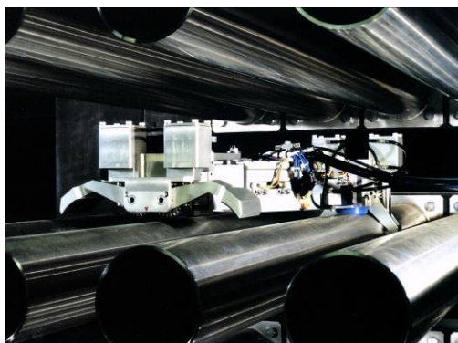
配管渡りロボット（溶接部検査）
