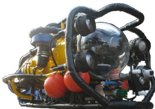
水中検査ロボット
