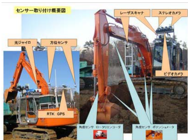
図 1.10 油圧ショベル概観とセンサ取付図（[8]の図5）
