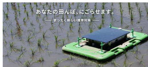
あなたの田んぼ、にござませす。 まったく新しい雑草対策 資料：有機米デザイン株式会社Webサイト 機能は除草ではなく抑草。 実証試験を経て2023年より販売開始。 他の抑草機ロボットと比べ、現時点で最も開発・普及が進んでいる フロート型、外部電源不要のソーラー発電、GPS機能内蔵の自律航行ロボ。 開発は有機米デザイン株式会社、販売は井関農機株式会社
