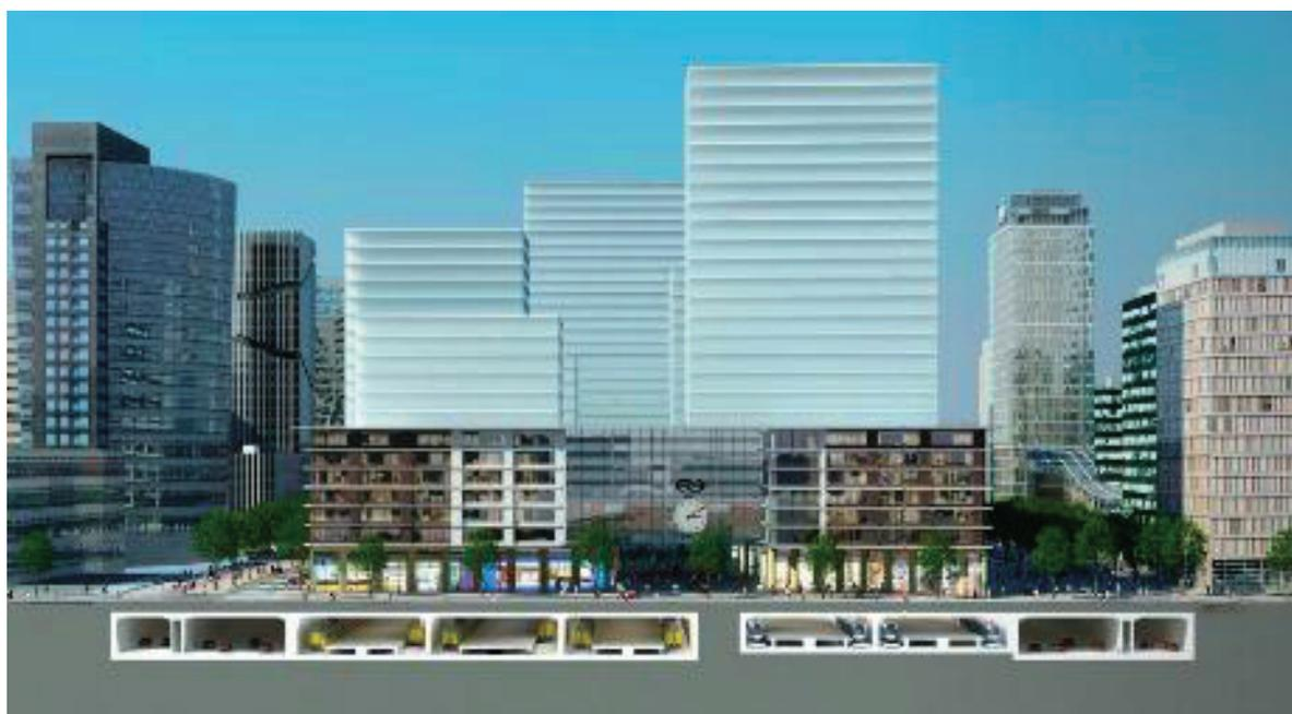
注) 人工地盤上空に都市機能を配置し、人工地盤下部に交通機能を配置する計画としている。この結果、人工地盤上空は人々の往来空間として確保されている。
