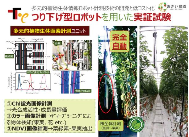
図37. 吊り下げ型ロボットを用いた実証試験
