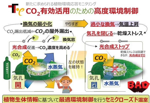
図31. CO<sub>2</sub>有効活用のための高度環境制御
