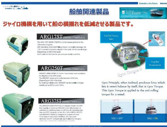
船舶関係では、船舶の揺れを低減させる装置の、アンチローリングジャイロ（以下、「ARG」）の開発、販売をおこなっています。30年前に三菱重工が衛星の姿勢制御技術を、民生品に転用して開発しました。開発当初から、当社が部品調達・組立・試験を担当して、波の揺れのシミュレーション
