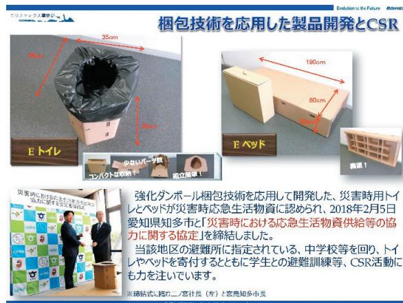
愛知県知多市と防災協定を締結して、災害時用の強化段ボール製のトイレとベッドを開発しました。災害による避難時の体育館での緊急用ですが、軽くて組立も簡単です。学校に無償で提供し、避難訓練では出張して、作成説明を実施しています。段ボールであるが、耐久性も十分で、中に空気が入り冬でも暖かい。評価が高く、他の自治体、学校、病院などに拡大していく予定です。防災の展示会でも出品し、すでに販売を始めています。
