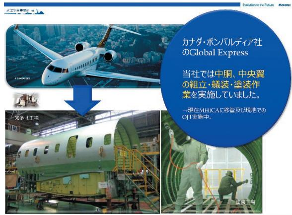
カナダのボンバルディア社の機体（グローバル・エクスプレス）を20年以上に渡り製造しました。販売価格がカスタマイズによっては100億円以上するという豪華な航空機ですが、この機体の中胴と中央翼、主翼の組立と塗装、艤装作業まで幅広く担当しました。三菱重工の方針によりカナダのMHICA社に作業が移管されたので、当社の作業者が立上げのため、出張して生産指導しています。
