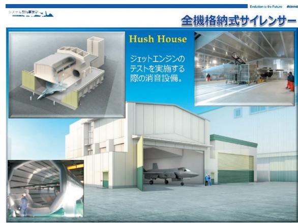
「ハッシュハウス」は、ジェットエンジンのベンチテストの消音設備です。水流で消音するシステムです。
