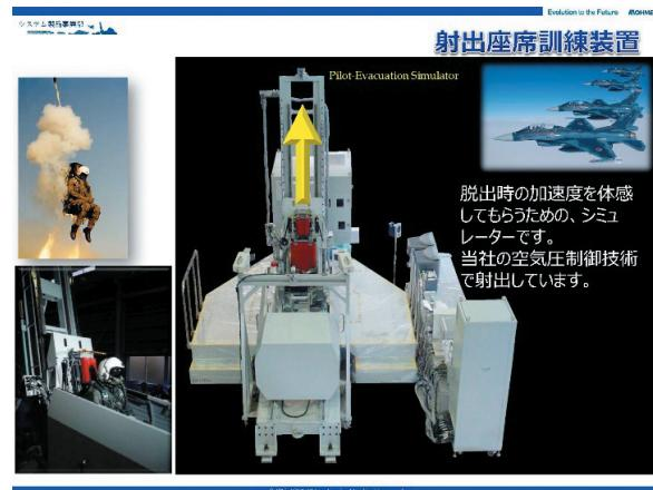
えるための訓練用の脱出装置です。空気圧で下から押し上げるだけで瞬間的に6G出て、パイロットが脱出時の負荷を体感できます。当社は、空気圧でシートを押し上げる制御システム開発と全体のとりまとめを担当しました。三菱重工の防衛省からの受注案件を、当社で受託しましたが、高付加価値の新事業として取り組みました。専門の技術者を採用でき、シミュレーターや試験装置の開発にめどが立ちました。新規事業であり、正確な原価の算出では苦労しましたが、ここ数年は黒字化できています。
