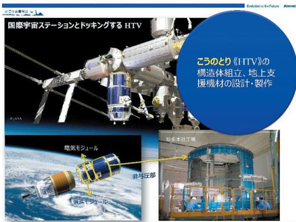
宇宙ステーション補給機HTV (H-II Transfer Vehicle、愛称：「こうのとり」) は、国際宇宙ステーションに食料、衣類などを供給する無人宇宙補給機ですが、その機体の一部の組立をおこなっています。宇宙環境での使用のため、製造環境や加工精度への要求が高く、現場管理にはより配慮しています。
