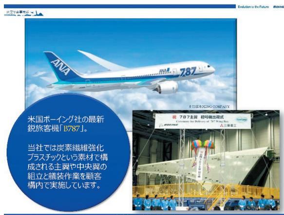
ボーイング787型機（愛称：ドリームライナー）の主翼の組立、艤装作業を行っています。主翼は全て炭素繊維複合材を使用し、三菱重工の大江西工場で組立をしています。当社の担当作業は、一部狭いところの中腰作業などもあり、作業者に配慮された設計になつてないところが残念です。
